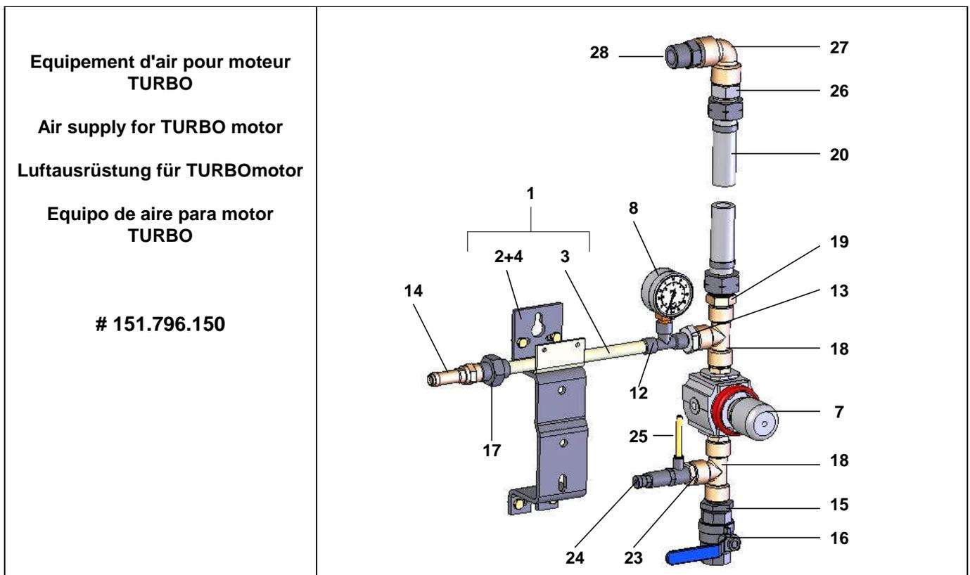
**Pièces spécifiques - Specific parts - Spezifische Teile - Partes específicas**
