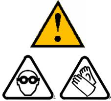
Um einen MV-Test durchzuführen, muss der Materialdruck reduziert werden (18 bar maximal), um Lackspritzer zu vermeiden. Es empfiehlt sich eine Schutzbrille und Handschuhe zu tragen.
