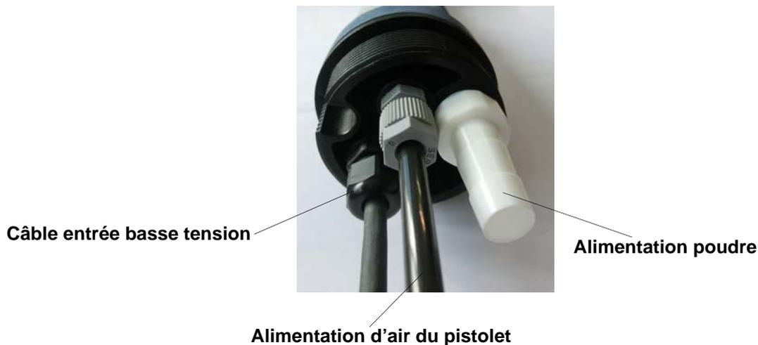
Monté sur un bras support creux, le pistolet de poudrage automatique AG 400 FCC est facilement nettoyable (peu de rétention). Toutes les connexions sont déportées à l'arrière du bras afin de faciliter le démontage de l'ensemble lors de la maintenance.
