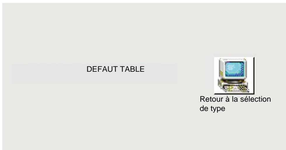
Lors d'un appui sur un des boutons d'enregistrement, si un des paramètres n'est pas valide dans les tables de pistolage, le message d'erreur " Défait table " s'affiche.
