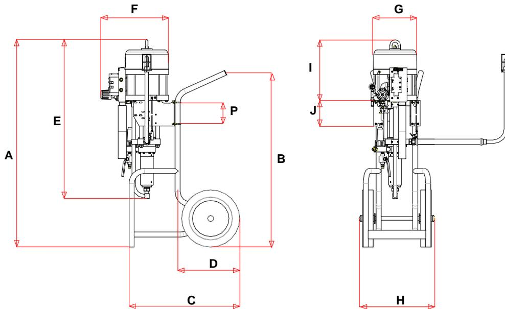
■ ABMESSUNGEN DER PUMPE 65.130 F2
