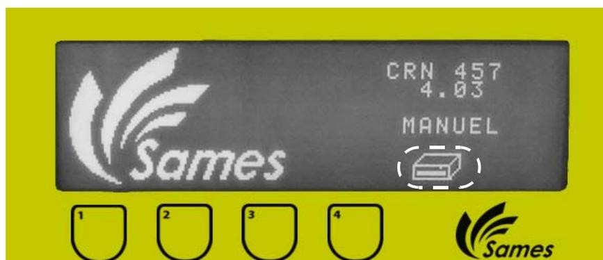
A pressão simultânea das teclas 1 e 2 (até o aparecimento do pictograma na parte superior, à esquerda) permite que o equipamento entre em funcionamento com os parâmetros configurados de fábrica. O operador encontra-se então em situação de primeira inicialização.
