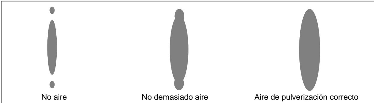
➤ **Para optimizar la pulverización Airmix®, no aumente la presión de aire de pulverización cuando se obtenga el correcto chorro.**
