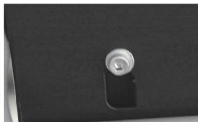
Vérifier visuellement que l'écrou 1/4 de tour s'est logé perpendiculairement à la rainure du CRN457.
