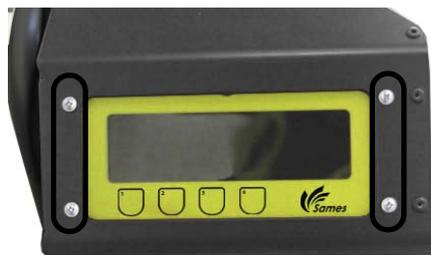
**Nota: La sécurisation et le maintien en position du module se fait à l'aide des 4 vis, rondelles et écrous 1/4 et d'une clé allen appropriée.**
