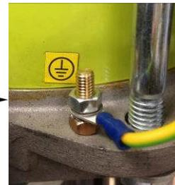
Desenroscar la tuerca de apriete (A), quitar la arandela (B), insertar la conexión (C) con su hilo de tierra (D) (sección mínima : 1,5 mm<sup>2</sup>) entre la arandela (B) y la arandela (D). Apretar de nuevo la tuerca de apriete. Conectar la otra extremidad del hilo a una verdadera "tierra" en conformidad con las reglas del país.
