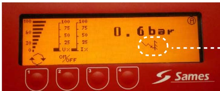
**Zeigt an, dass der Generator kurzgeschlossen ist: die Leistungsfähigkeit der Ladung sinkt auf Mittelmaß.**
