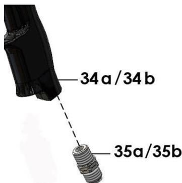
Dévisser le raccord tournant (35a/35b) du corps du pistolet (34a/34b) au moyen de la clé livrée avec le pistolet.
