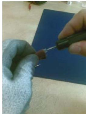
Encajar el extremo enroscándolo en el orificio pretaladrado sujetando el cable con la tela de lijar.
