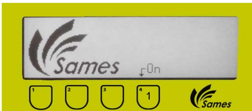
**[1]: Mit dieser Taste wird der Standby-Betrieb verlassen.**
