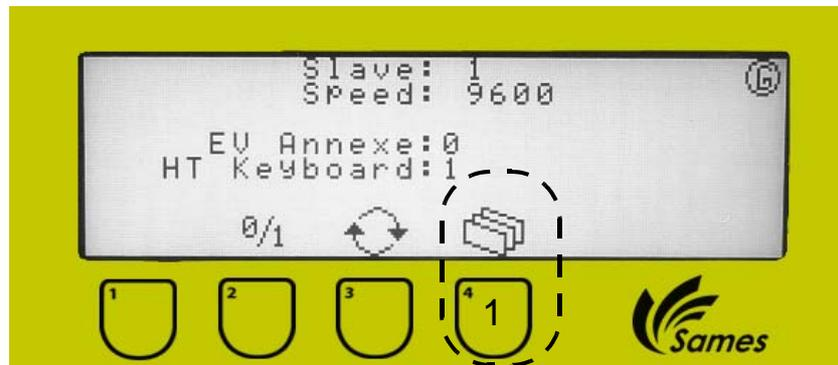
**[1]: Mit dieser Taste kann das folgenden Menü oder durch einen Druck von länger als zwei Sekunden der Reinigung-Bildschirm aufgerufen werden.**
