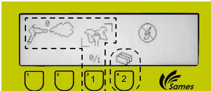
**[1]: Mit dieser Taste wird der Reinigungsbetrieb ein- oder abgeschaltet.**
