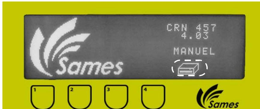
Durch gleichzeitiges Drücken der Tasten 1 und 2 (bis zum Erscheinen des Ikons) wird die Ausrüstung mit den Werkseinstellungen gestartet. Dadurch Befindet sich der Bediener in der Situation eines erstmaligen Einschaltens.
