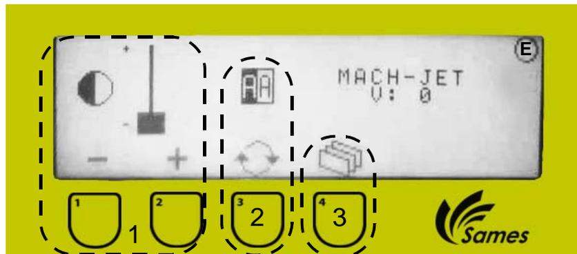
**[1]: In diesem Feld wird der Bildschirmkontrast geändert. Durch drücken der Tasten wird:**
