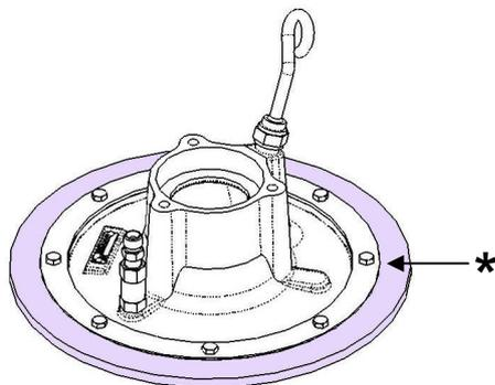
**\* Joint de plateau / Plate seal / Flachdichtung / Junta de plato**
