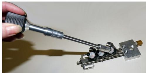
**Si la vanne est bloquée**, insérer une clé Allen de 4 mm à l'arrière de l'outil, placer l'ensemble sur la vanne et dévisser.
