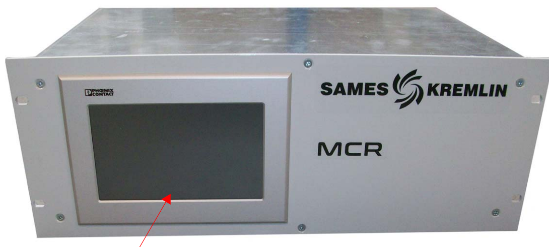
Pulpit dotykowy operatora 7 cali /kolorowy 65535 kolorowy, 800x 480 pixels
