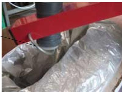
**Le bras (1 pompe à poudre uniquement) peut pivoter sur le côté afin de dégager l'accès et se bloquer en position latérale.**
