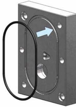
Placer un joint neuf sur le flasque arrière.
