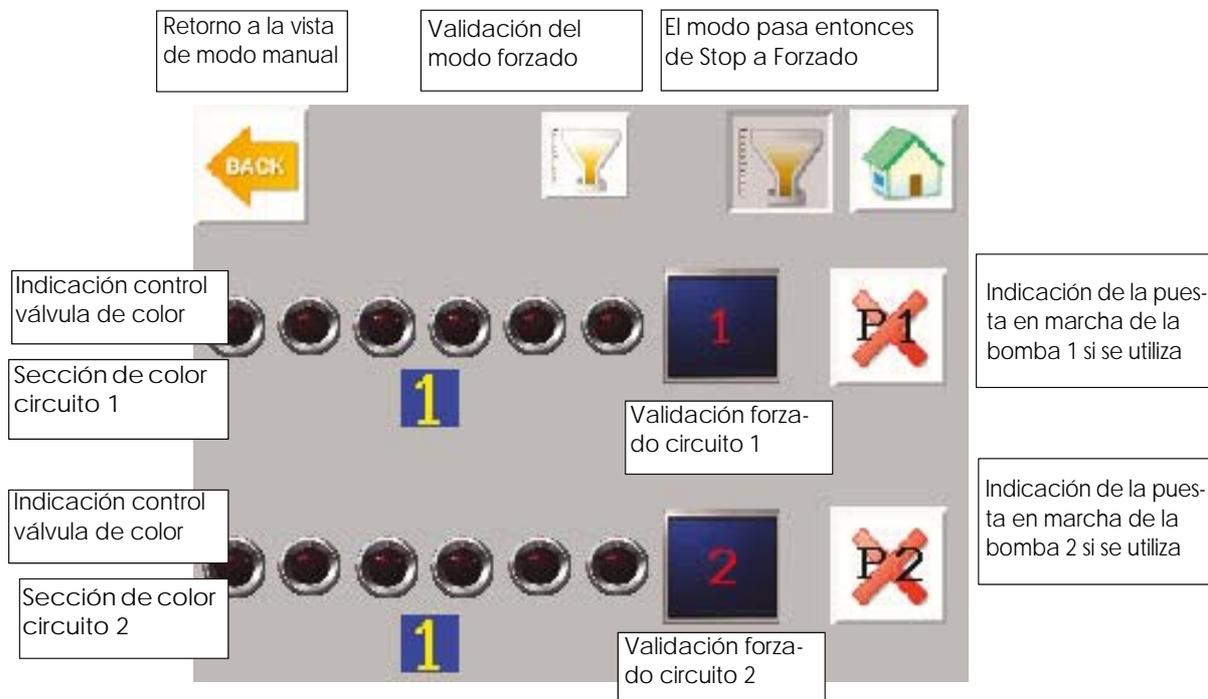
Este modo principalmente sirve para **calibrar el caudal de pintura** del sistema. No hay ninguna interacción con el módulo SLR.
