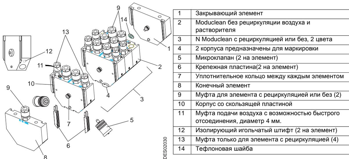
**Примечание:** сборка блока Moduclean происходит со сторон закрывающего элемента и конечного элемента с помощью 4 винтов.
