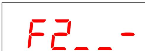
Ce menu est utilisé pour le rinçage. Pour rincer la machine, activez **OK** lorsque vous êtes sur le menu F2.
