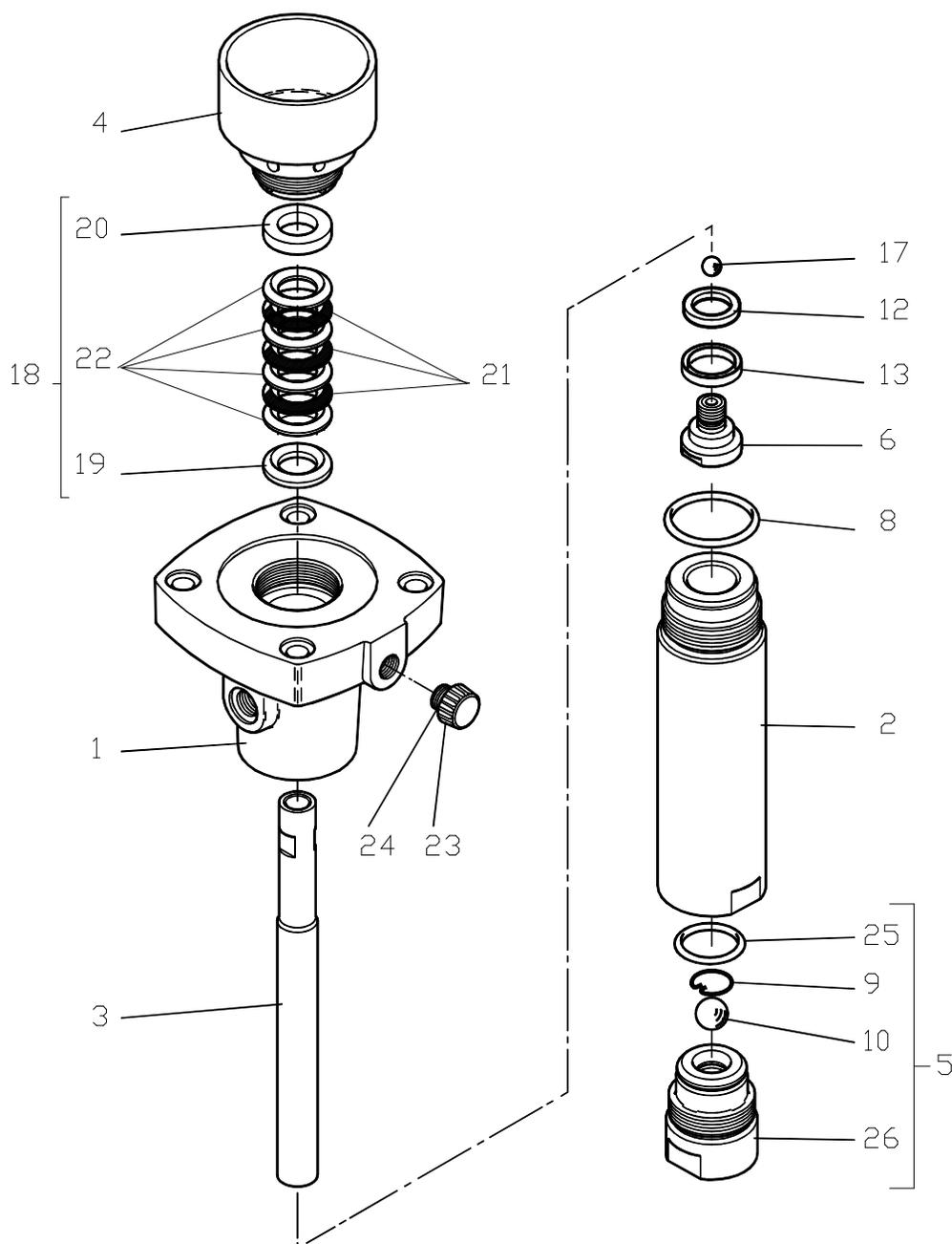
**Hydraulique avec joint GT (à partir de la pompe N° série : 905 600)**
