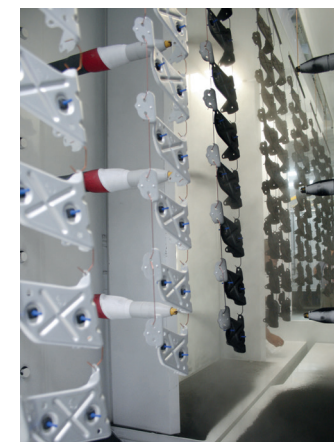
Installation standard avec armoire MCR et deux réciprocaturs
